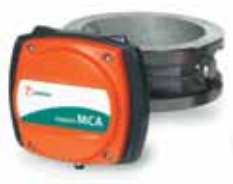
Koncentrationsmätare MetsoMCA Mikrovågsbaserad mätare. Främst avsedd för pappersmassa. Metso Automation
